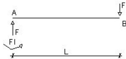
*Esempio 8: data la struttura in figura determinare le reazioni vincolari*
