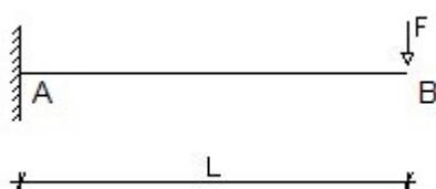
anche in questo caso il sistema è isostatico in quanto G.L.=G.V.; sostituendo al vincolo triplo presente in A le reazioni vincolari corrispondenti ottengo
