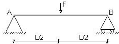
il numero di vincoli è sufficiente, infatti la struttura ha 3 gradi di libertà ed i gradi di vincolo sono 3 di cui 2 nel vincolo in A (cerniera) ed uno nel vincolo in B (carrello); i vincoli sono inoltre ben posti in quanto il centro di rotazione del vincolo in A è in corrispondenza della cerniera mentre il centro di rotazione del vincolo in B si trova sulla retta perpendicolare al piano di scorrimento del carrello e passante per il centro della sua cerniera.
