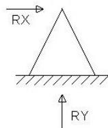
che impedisce qualsiasi traslazione permettendo invece la rotazione ed il *doppio pendolo* che impedisce un movimento di traslazione e la rotazione
