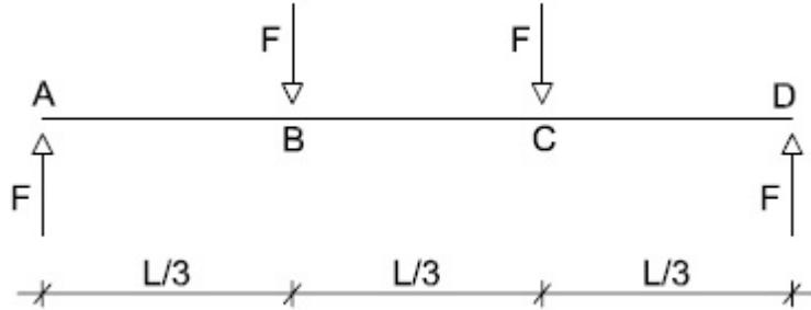
*Esempio 10: dopo aver verificato che la seguente struttura è isostatica calcolare le reazioni vincolari e rappresentarle graficamente (la struttura è ricavata da quella dell'esercizio 9 invertendo la direzione delle forze)*
