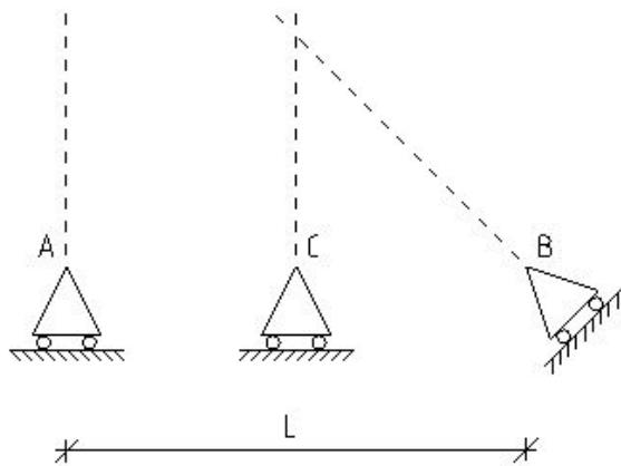
Analogamente a quanto visto nel caso precedente anche in questo caso è sufficiente inclinare uno dei carrelli per realizzare un sistema isostatico. In questa nuova configurazione non esiste nessun punto che sia il c.i.r. per tutti e tre i vincoli e quindi il sistema può definirsi isostatico.
