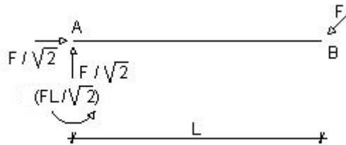
*Esempio 9: dopo aver verificato che la seguente struttura è isostatica calcolare le reazioni vincolari e rappresentarle graficamente*
